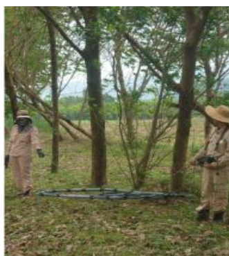
検知器で地中に埋まる不発弾を探索する作業員。
