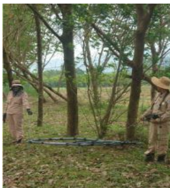
Hình ảnh nhân viên sử dụng thiết bị rà tìm vật liệu chưa phát nổ trong đất
